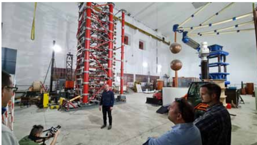
Obr. 7. Laboratórium vysokých napätí FEI STU. Transformátorová kaskáda s maximálnym výstupným napätím 1200 kV, 1500 kVA a generátor napäťového impulzu s amplitúdou do 2500 kV a energiou 100 kJ.
