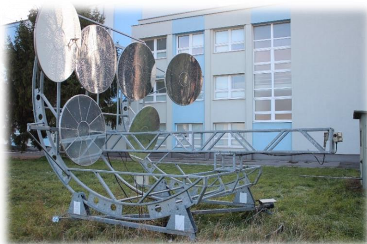
Obrázok 6 Parabolický solárny koncentrátorový zdroj
