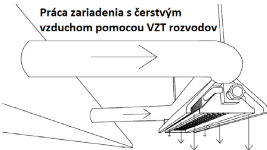
Obr. 2. Riešenie vírusovej čistoty multifunkčným zariadením MESLED. [1]
