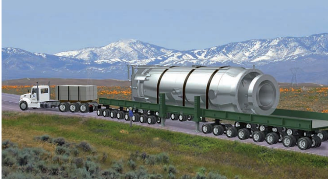
Transport nádoby MMR spoločnosti NuScale s elektrickým výkonom 45 MWe a tepelným výkonom 160 MWt [3]
