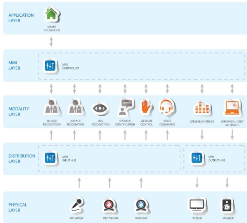
Obr. 42 Vrstvový model architektúry MMI
