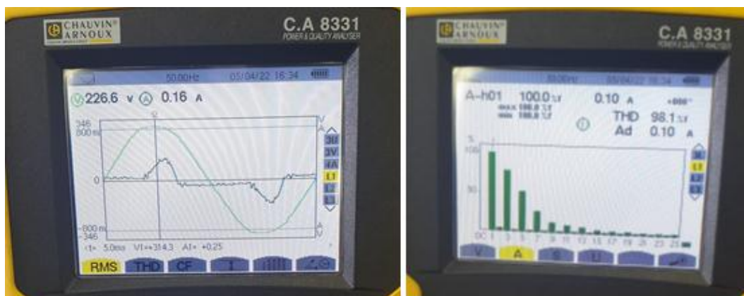
a) b) Obr.2 Priebieh odoberaného prúdu skúmaného PC zdroja zaznamenaný sieťovým analyzéróm Chauvin Arnoux C.A 8331 pri zaťažení 12 W a). FFT odoberaného priebehu prúdu zdroja pre zaťaženie 60 W b).
